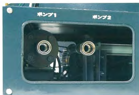
ポンプ吐出口
